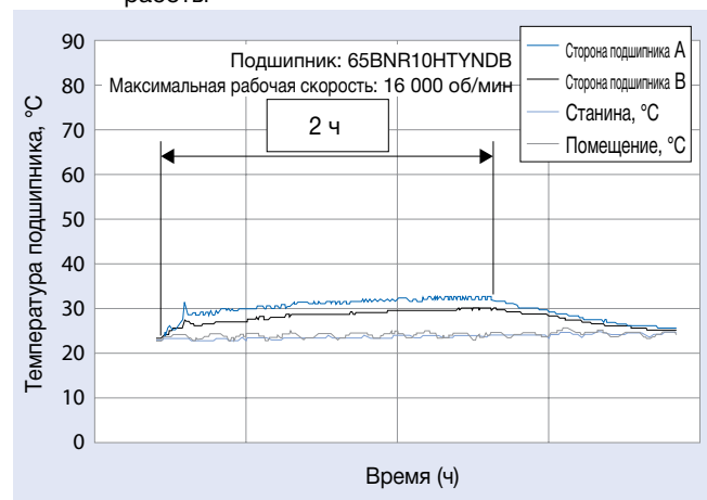
Рис. 3.3 Изменение температуры при прерывистом режиме работы
