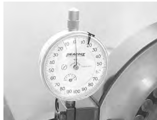
Рис. 1.15 Измерение ширины дистанционного кольца
