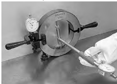
Рис. 1.11 Регулировка вписанного диаметра калибра GN
