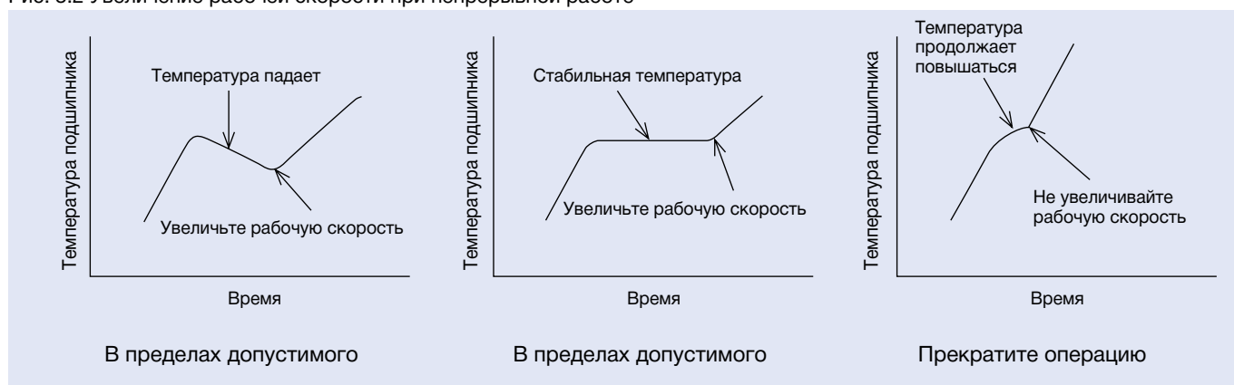
Рис. 3.2 Увеличение рабочей скорости при непрерывной работе
