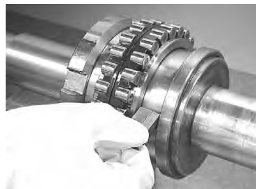
Рис. 1.15 Измерение ширины дистанционного кольца
