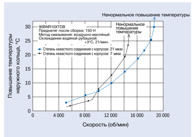
Рис. 5.3 Влияние зазора между подшипником и корпусом на предельную скорость
