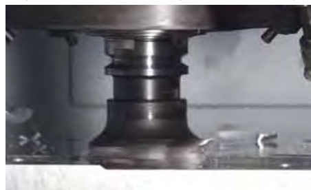
Торцовая фреза: \phi 80 Обрабатываемый материал: S50C Частота вращения: 1 200 об/мин 504 см 3 /мин
