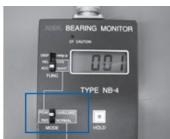
Записывание вибраций, вызванных царапиной внутри подшипника (ENVELOPE)
