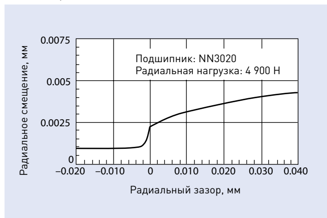
Рис. 4.11 Радиальный зазор в двухрядном цилиндрическом роликовом подшипнике и изменения жесткости
