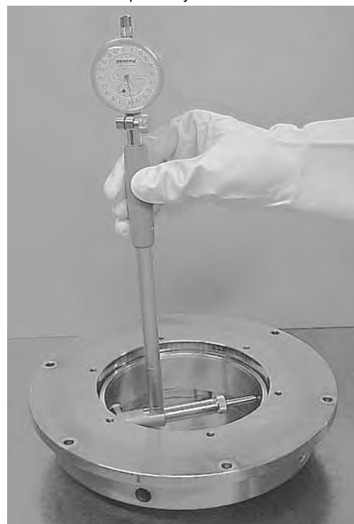
Рис. 1.11 Регулировка вписанного диаметра калибра GN
