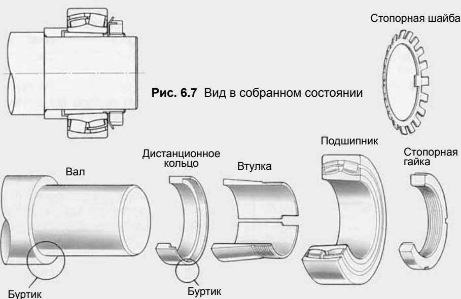
Рис. 6.8 Способ с применением стопорной гайки
