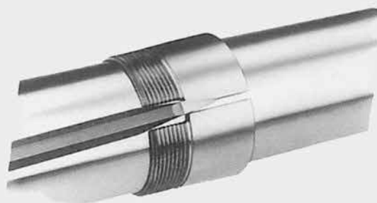
Рис. 2.5 Способ расширения прорези втулки
