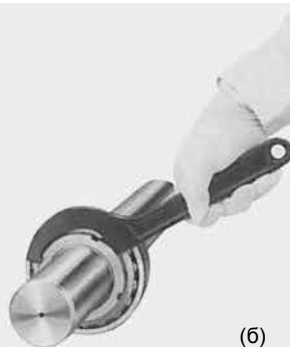
Рис. 2.6 Способ затяжки стопорной гайки
