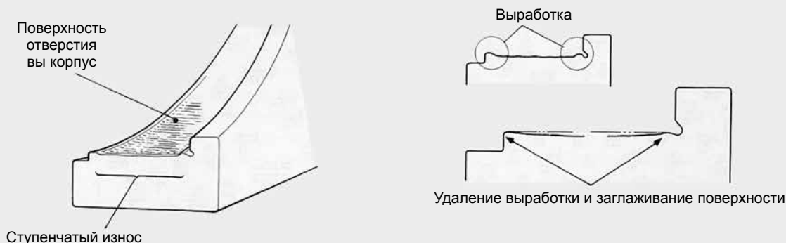
Рис. 8.5 Коррекция ступенчатого износа на поверхности отверстия корпуса.
