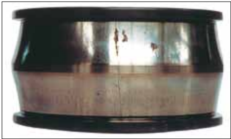
Разрушение внутреннего кольца
